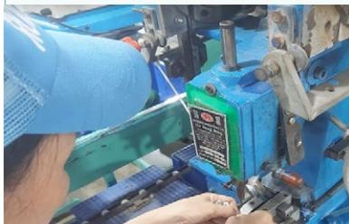
员工的手需放在打扣区域固定部件，虽已装有防护装置，但仍未完全消除在操作时存在的手指被压伤的风险。
