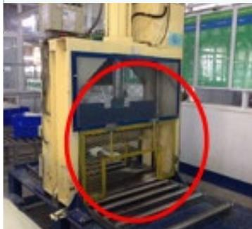
橡胶切片机上下移动时，切片区防护不足且仅有一个控制机器运行的按钮。当员工用一只手启动控制按钮，同时用另一只手将材料推入机器里面时，存在手或手臂被压伤的风险。
